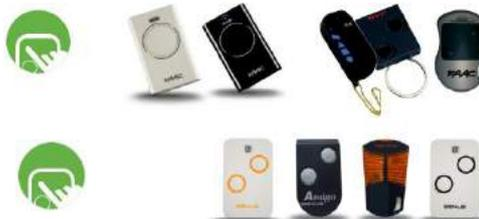
**ATTENTION : Vérifier que la télécommande originale FAAC est une « MASTER » : En appuyant n'importe quelle touche, le LED doit émettre un double clignotement. Si le LED s'allume fixe, c'est une SLAVE et la copie est impossible**
